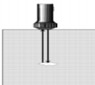
图 1-1 超声探伤基本工作原理
