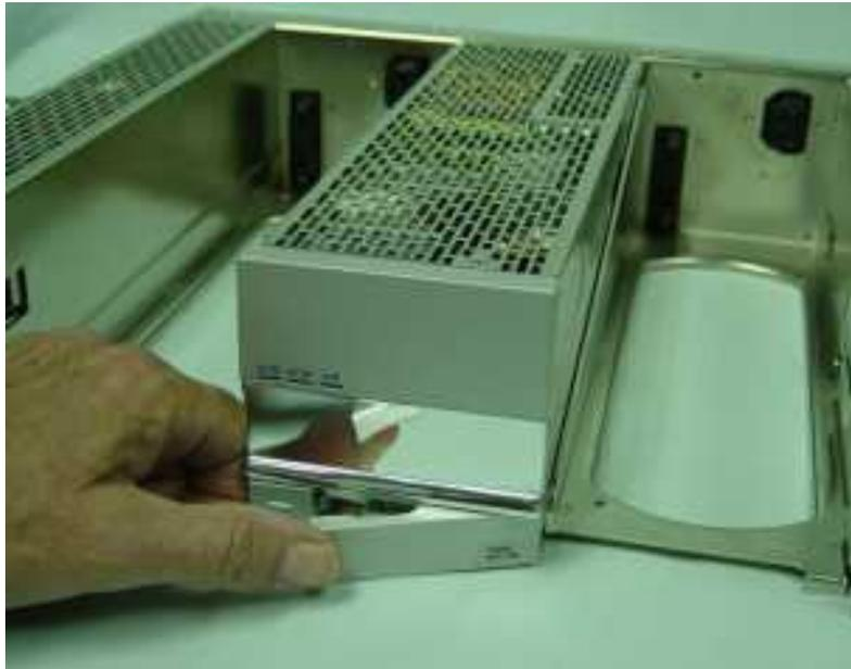
图 B2 - 整流模块安装与替换
