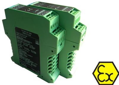
TD10x-EX-485-xx 输入隔离式安全栅，可以从安全区向危险区提供隔离的直流电源供给变送器或者传送器，并将危险区的 RS-485 数字信号转换为隔离的 RS-485 或者 RS-232 数字信号传输到安全区，同时提高工业生产过程自动控制系统的抗干扰能力，保证系统的稳定性和可靠性。
