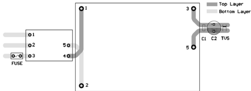
图 6: EMC 推荐电路 PCB 布板图
